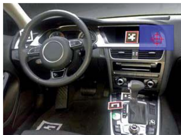
Abbildung 13: Eye-Tracker-Analyse des Blickfeldes mit AOI und Erkennungsmarkern
