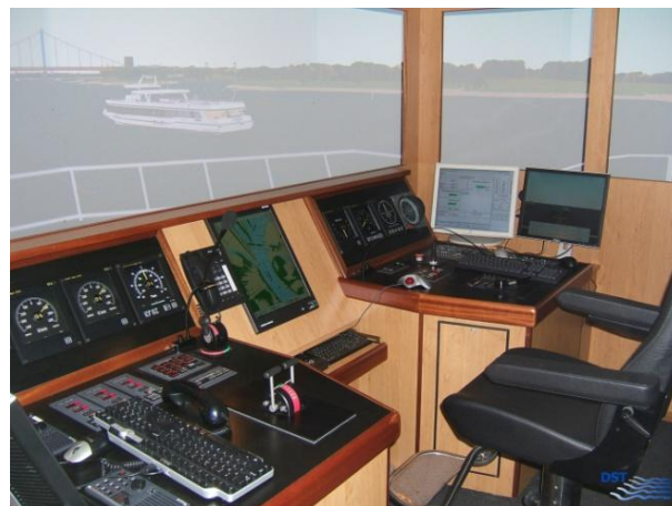
Abbildung 8: Fahrstand – Große Brücke mit 210°Vorraussicht und Rücksicht durch Bildschirme (DST, 2013).
