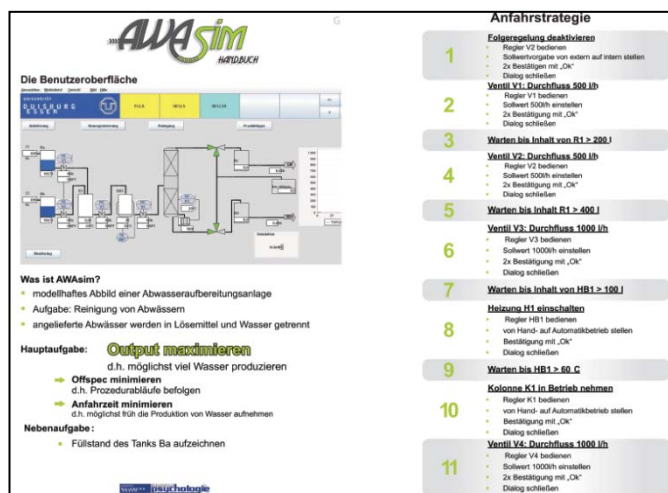
Abbildung 2: AWAsim SOP zur Anfahrprozedur.
