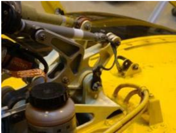
Abbildung 6: Beispiel für ein no-go-Bild: hier ist eine Schraube gelöst
